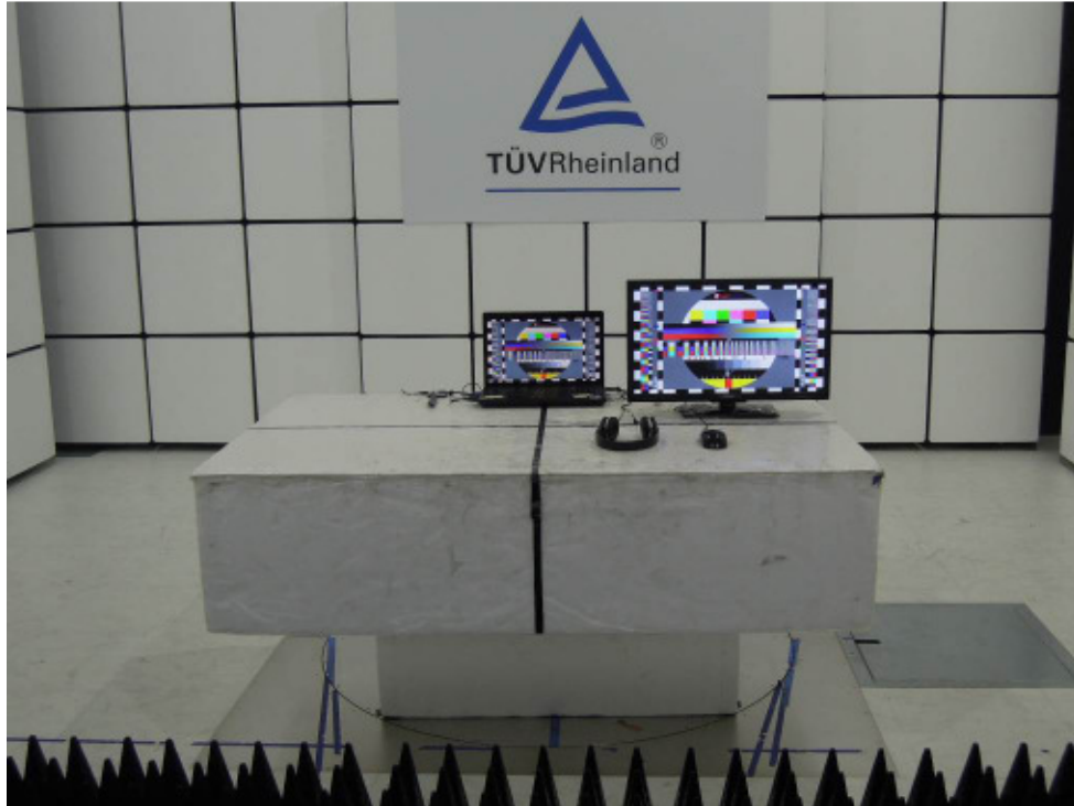
Picture 4: Radiated Emission, Above 1 GHz (EN 301 489-3 V2.1.1)
