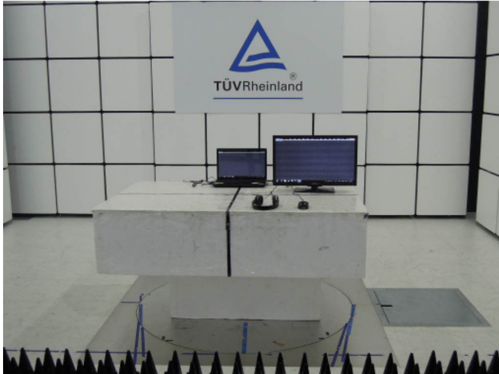
Picture 3: Radiated Emission, Above 1 GHz (EN 301 489-3 V1.6.1)
