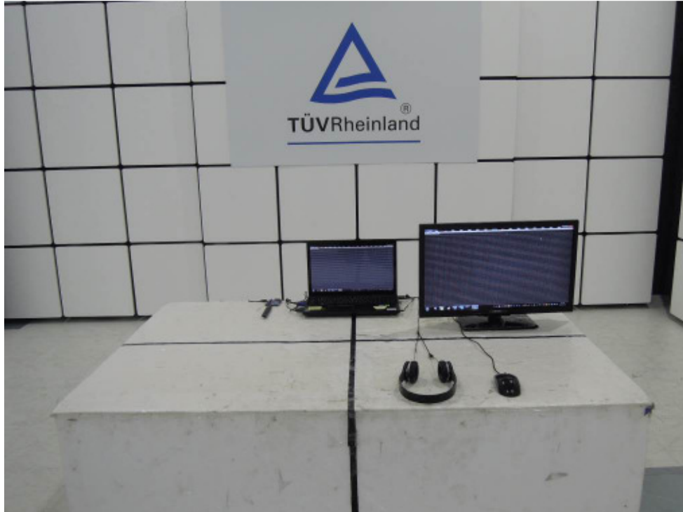
Picture 1: Radiated Emission, 30 - 1000 MHz (EN 301 489-3 V1.6.1)
